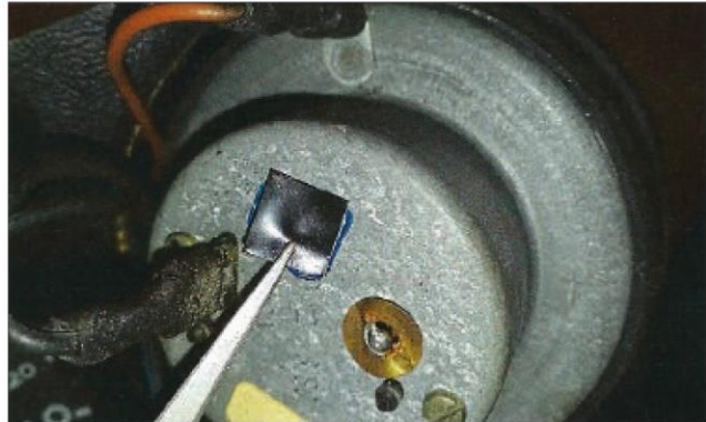
Sieht aus wie unscheinbares Etikett: Selbstklebender Chip auf Rückseite Instrument
